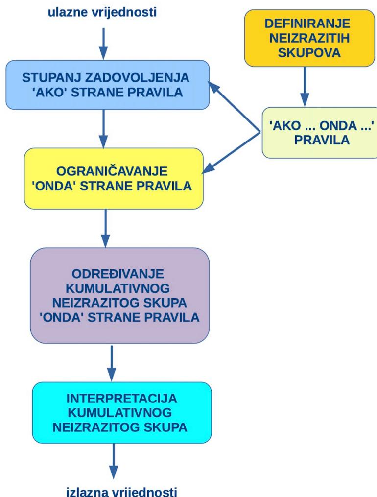
Slika 5-20. Shematski prikaz postupka neizrazitog zaključivanja
