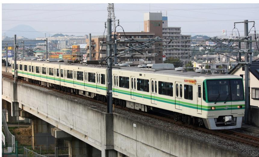
Slika 1-6. Jedan od prvih primjera primjene neizrazitih sustava u automatskom vođenju je Sendai Subway 1000<sup>6</sup> željeznica iz Japana kod koje je neizraziti regulator korišten za regulacije brzine vlaka. Rezultat njegove primjene je udobnija vožnja i 10% ušteda energije.
